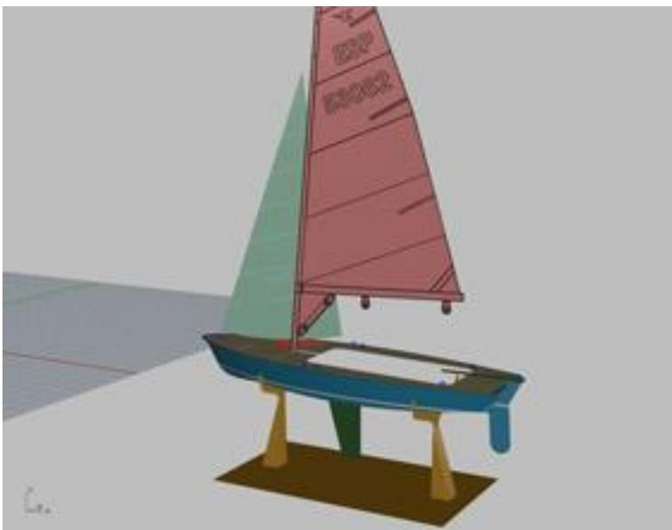
*Con la colocación del foque, la orza y el timón, se dará por concluido el montaje.*
