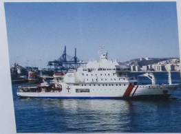
ESPERANZA DEL MAR (17) Construido en 2007 por el astillero Construcciones Navales - Gijón Eslora: 91,00 m - Manga: 15,00 m - Puntal: 7,00 m Propulsión: 2 Motores diesel MAN B&W - 7.340 CV - Velocidad: 17 nudos En servicio
