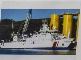
JUAN DE LA COSA Construido en 2009 por el astillero Construcciones Navales - Gijón Eslora: 70,0 m - Manga: 14,0 m - Puntal: 7,2 m Propulsión: 2 Motores diesel MAN B&W - 4.850 CV - Velocidad: 18 nudos En servicio
