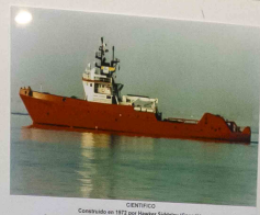
CIENTÍFICO Construido en 1972 por Hovest Fabry (Francia) Construido como pesquero. Reconvertido en 1989 en buque de investigación oceanográfica y apoyo a operaciones. Adaptado como hospital desde 2001 hasta 2008 Número: 1972 CV 10000 - Eslora: 52,1 mtr - Manga: 11,1 mtr - Puntal: 5,1 mtr Eslora: 52,2 mtr - Manga: 11,0 mtr - Puntal: 5,1 mtr Propulsión: Motor diésel Kubota 1200 - 2.000 CV con motor diésel de 1.000 CV cada uno, conectados a los ejes de control. Velocidad: 12 nudos Activado desde 2011 en Gijón
