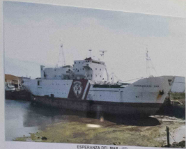
ESPERANZA DEL MAR (S-17) Entregado en 1982 por Astilleros de Melilla - Párra de Melilla Su construcción empezó en 1977 como portaviones, siendo reconvertido al ser reintegrado por el Instituto Social de la Marina. Eslora: 81,7 m - Manga: 14,4 m - Puntal: 7,2 m Propulsión: Motor diesel Sauer BROWNIE - 2.420 CV - Velocidad: 12 nudos Designación: 2002 - GIGG
