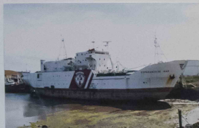
ESPERANZA DEL MAR (1) Entregado en 1982 por Astilleros de Mallorca - Palma de Mallorca Su construcción empezó en 1977 como patrullero, siendo reconstruido al ser adquirido por el Instituto Social de la Marina. Eslora: 61,7 m - Manga: 14,1 m - Puntal: 7,7 m Propulsión: Motor diésel Olay R6V4M308 - 2.430 C.V. - Velocidad: 12 nudos Capacidad: 2000 UOJA
