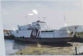
ESPERANZA DEL MAR (1) Construido en 1993 por el astillero de Brest, Paises de Maldivas. Es construido como buque de patrullaje, siendo reconvertido a un buque de apoyo a la investigación oceanográfica y apoyo a plataformas. Eslora: 81,7 m - Manga: 14,5 m - Puntal: 7,3 m Propulsión: Motor diesel Isuzu 900000 - 1.400 CV - Velocidad: 13 nudos Desplazado: 3002 - 01/01/2011
