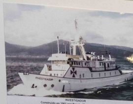
INVESTIGADOR Construido en 1917 por Estaleiros Reunidos (Brasil) Construido como buque de Prospección. Adaptado como hospital desde 1983 hasta 1996 Reconvertido en 1987 buque de investigación oceanográfica y apoyo a operaciones 1992 INVESTIGADOR Eslora: 42,4 mtr - Manga: 7,4 mtr - Puntal: 4,8 mtr Propulsión: 2 Motores diésel Lister Blackstone SC6000E - 900 CV En servicio como buque de investigación oceanográfica y apoyo a operaciones Activado desde 2011 en Gijón
