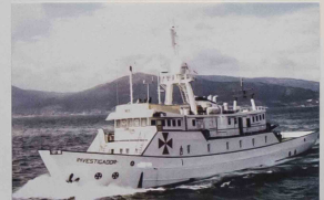
INVESTIGADOR Construido en 1961 por Brooke Marine (Reino Unido) Construido como buque de Patrullero. Adaptado como hospital desde 1993 hasta 1994. Reconstruido en 2007 tras su investigación oceanográfica y apoyo a plataformas. Nombres: 1961: INVESTIGADOR - 1962: CESER - 1967: INVESTIGADOR 2 1992: INVESTIGADOR Eslora: 42,4 m - Manga: 7,4 m - Puntal: 4,9 m Propulsión: 2 Motores diésel Lister Blackstone EP6M96 - 950 C.V. Es servicio como buque de investigación oceanográfica y apoyo a plataformas.
