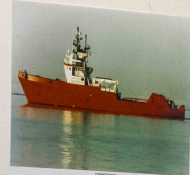
ESPERANZA DEL MAR (S-17) Construido en 1977 por Astilleros de Melilla - Párra de Melilla Su construcción empezó en 1977 como portaviones, siendo reconvertido al ser reintegrado por el Instituto Social de la Marina. Eslora: 81,7 m - Manga: 14,4 m - Puntal: 7,2 m Propulsión: Motor diesel Sauer BROWNIE - 2.420 CV - Velocidad: 12 nudos Designación: 2002 - GIGG
