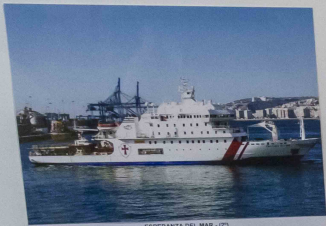
ESPERANZA DEL MAR (17) Construido en 2001 por los Constructores Navales - Gijón Eslora: 87,2 mtr - Manga: 13,1 mtr - Puntal: 7,7 mtr Propulsión: 2 Motores diésel MAN 902 - 7.240 CV - Velocidad: 17 nudos En servicio
