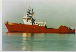
CIENTIFICO Construido en 1977 por el astillero de Brest (Francia). Construido como pesquero. Reconvertido en 1989 en buque de investigación oceanográfica y apoyo a plataformas. Adaptado como hospital desde 1992 hasta 2000. Nombres: 1972: LAPE IMBICY - 1984: OCEAN HUNTER - 1986: CIENTIFICO Eslora: 42,0 m - Manga: 13,0 m - Puntal: 5,4 m Propulsión: Motor diesel Kubota 12000 - 2000 CV - más dos motores diesel de 6.100 CV cada uno, conectados a los ejes del eje propulsor - Velocidad: 12 nudos Arrendado desde 2021 en Vigo
