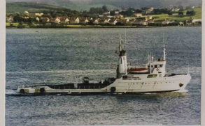
REMOLCAGORE BAT Construido en 1968 por Cantieri Navali M. & B. Benetti (Italia) Construido como activador off-shore. Adaptado como hospital desde 1997 hasta 2001. Eslora: 65,1 m - Manga: 11,4 m - Puntal: 4,8 m Nombres: 1968: SAUFER OSEA - 1990: VIE SERVICE - 1994: NANOCOMA 1996: REMOLCAGORE BAT - 2001: COME DE GONDOMAR - 2010: DOLA Propulsión: 2 Motores diésel Fiat 6208.850 - 2.700 C.V. - Velocidad: 12 nudos Actualmente desplazado en Nigeria en 2015.
