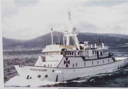
INVESTIGADOR Construido en 1979 por el astillero de Brest (Francia). Construido como buque de Patrullaje. Adaptado como hospital desde 1993 hasta 1996. Reconvertido a 2007 buque de investigación oceanográfica y apoyo a plataformas. Nombres: 1981: PROCESOR - 1982: CEDER - 1983: CIENTIFICO - 1987: INVESTIGADOR - 1992: INVESTIGADOR Eslora: 42,4 m - Manga: 7,4 m - Puntal: 4,9 m Propulsión: 2 Motores diesel Volvo Penta 120000 - 1000 CV En servicio como buque de investigación oceanográfica y apoyo a plataformas
