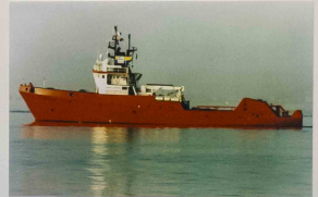
CIENTÍFICO Construido en 1972 por Hawker Siddeley (Canadá) Construido como buque de patrullero. Reconstruido en 1989 en base de investigación oceanográfica y apoyo a plataformas. Adaptado como hospital desde 2002 hasta 2006. Nombres: 1972: CAPE SIMON - 1984: OSCAR HUNTER - 1986: CIENTÍFICO Eslora: 62,0 m - Manga: 11,0 m - Puntal: 5,5 m Propulsión: Motor diésel Kubota T904C - 2.000 C.V. más dos motores diésel de 1.000 C.V. cada uno, colocados a los lados del centro - Velocidad: 12 nudos Armado desde 2025 en Vigil.
