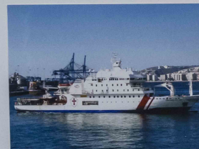
ESPERANZA DEL MAR (2) Construido en 2001 por Ipar Construcciones Navales - Gijón Eslora: 67,2 m - Manga: 13,1 m - Puntal: 7,2 m Propulsión: 2 Motores diésel MAN 9S23 - 7.340 C.V. - Velocidad: 17 nudos Es servicio
